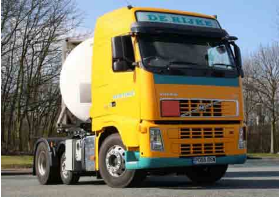
Bild4 (Volvo Lastvagnar): Tvåaxlig dragbil för påhängsvagn blir treaxlig med pusher-axel.
