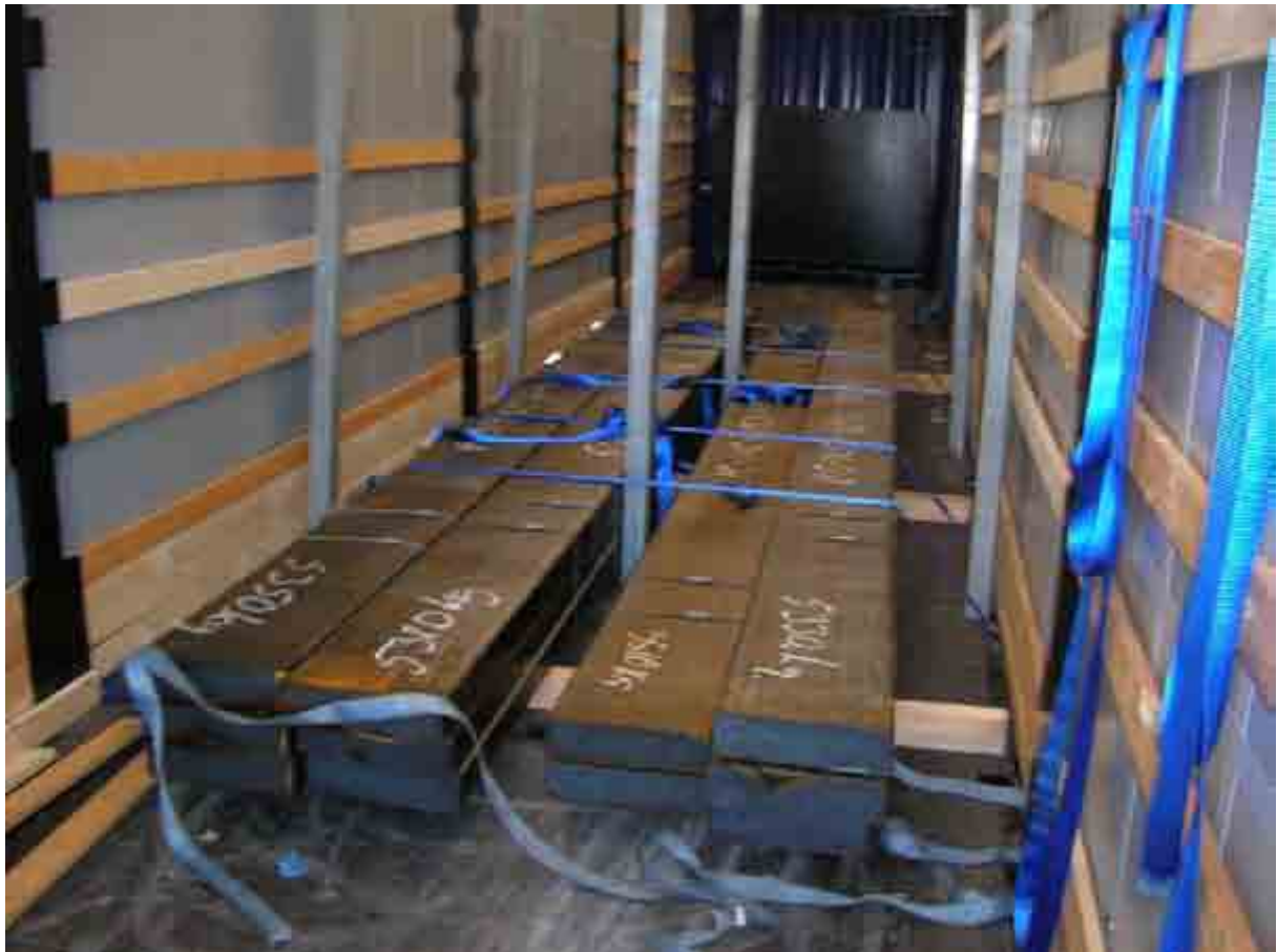
Bild 1: Bristfällig lastsäkring, bl.a. saknas förstängning framåt för stålämnen på semi-trailern.
