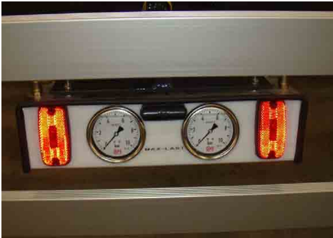
Bild 5 (Parator): Manometrar för bälghöjning per axelgrupp på flissläpvagn med lampa som lyser vid maxlast. Från tjänstevikt till max bruttovikt varierar manometertrycket mellan ca 0,5 till 4,5 bar.
